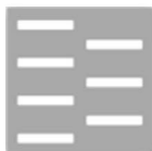
Foro Rettangolare ALTERNATO Langlöcher mit scharfen Ecken versetzt
