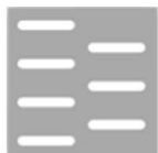
Foro Oblungo ALTERNATO Langlöcher mit abgerundeten Ecken versetzt
