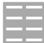
Foro Rettangolare PARI Langlöcher mit scharfen Ecken parallel
