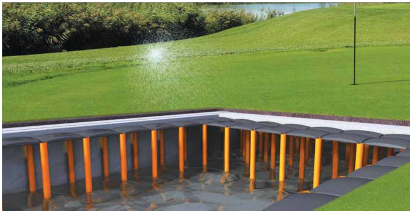
Esempio di applicazione. Vasca di raccolta sfruttabile come impianto di irrigazione in un campo da golf.
