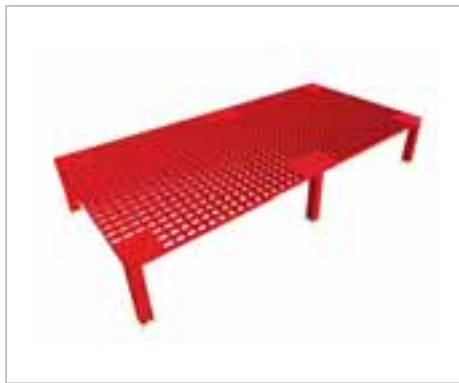
Modellazione shell+solid struttura indeformata.
