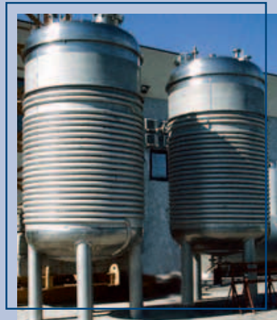
Reattori mc. 20 PED con agitatore e semitubo Reactors mc. 20 PED with stirrer and half-pipe Drukbehälter mc. 20 PED mit Rührwerk und Heizröhre Réacteur mc. 20 PED avec agitateur et demi-tuyau
