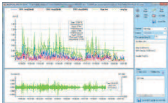
NS1 "Protezione lavoratori" Modulo vibrazioni: valutazione dell'esposizione alle vibrazioni, analisi dei tracciati temporali X-Y-Z.
