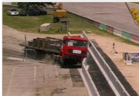
Crash test eseguiti presso il centro prove AISICO di Anagni (FR)
