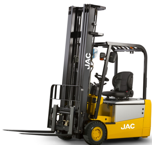
CPD16-SA3 Portata 1.600 Kg Batteria 48V/500Ah
