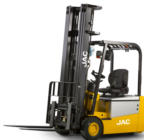
CPD18-SA3 Portata 1.800 Kg Batteria 48V/500Ah
