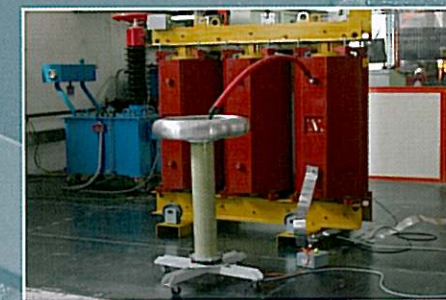
Misura di Scariche Parziali
