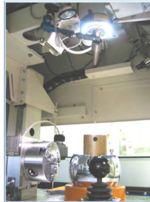
Vista dell'interno della camera di lavoro con tavola X-Y-Z con azionamento manuale mediante joystick
