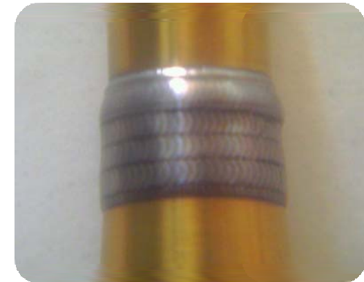
Saldatura su punzone rivestito TiN
