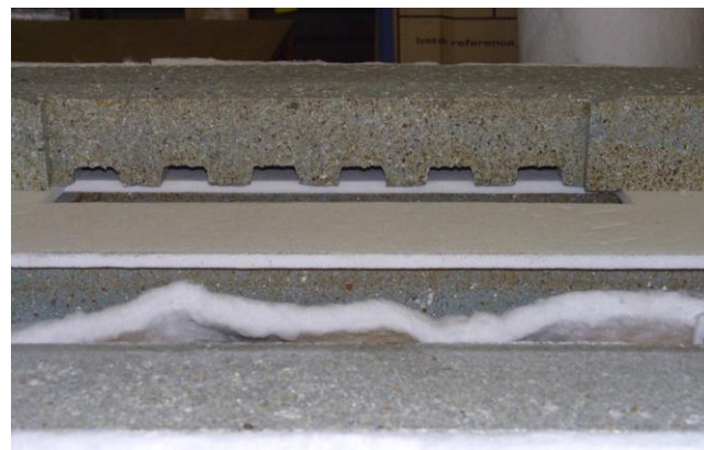
Fig.17 - Dettaglio piastra refrattaria vano di carico
