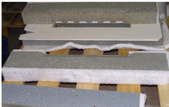
Fig.16 - Particolari costituenti la culla del vano di carico
