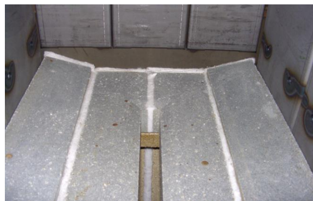
Fig.15 - Culla del vano di carico in refrattario
