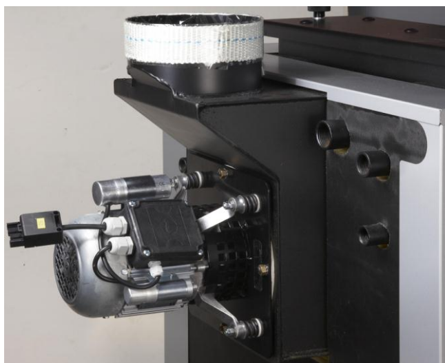
Fig.25 - Ventilatore aspirazione fumi
