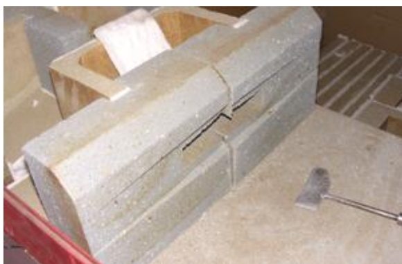
Fig. 15 - Particolari in refrattario della camera di combustione
