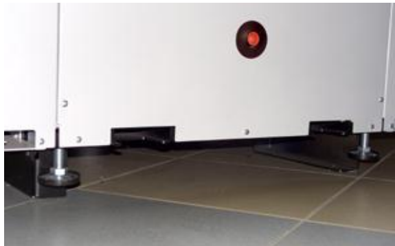
Fig. 20 - Dettaglio zona trasporto con transpallet e piedini di regolazione
