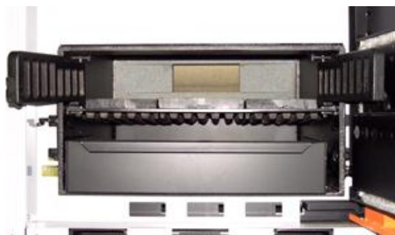
Fig. 12 - Vista frontale griglia mobile aperta e foro passaggio gas in camera di combustione
