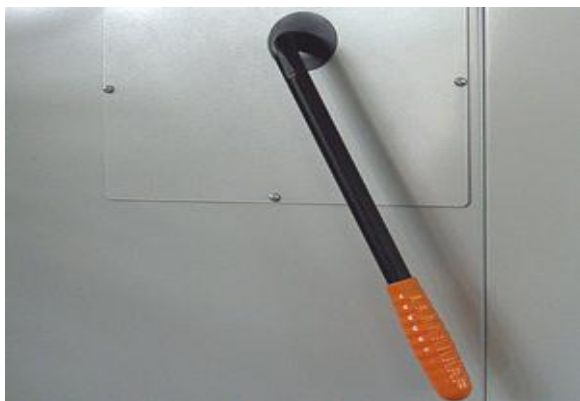
Fig. 22 - Dettaglio leva azionamento esterno turbolatori
